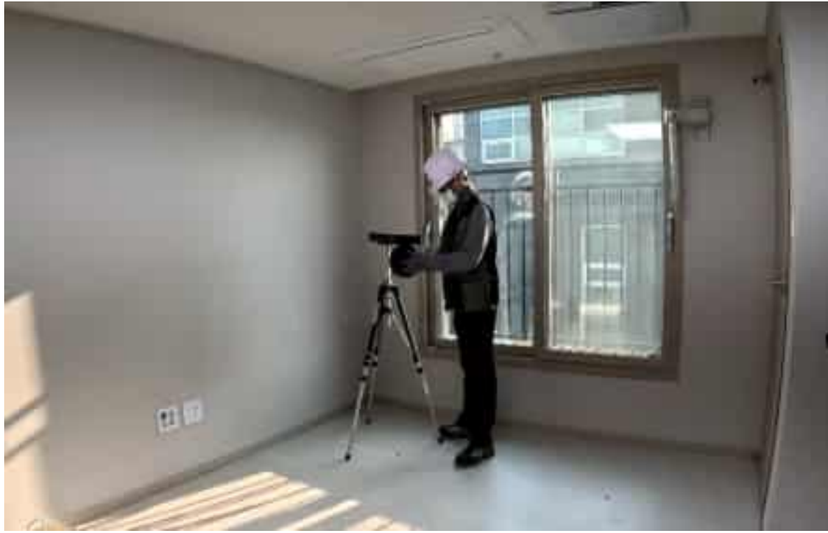
바닥충격음 성능검사 (음원실) - 측정보조 기기 / 중량충격음(고무공)
