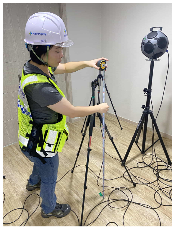
성능검사기관(국토안전관리원) 현장 관리 - 측정장비 설치 상태 확인
