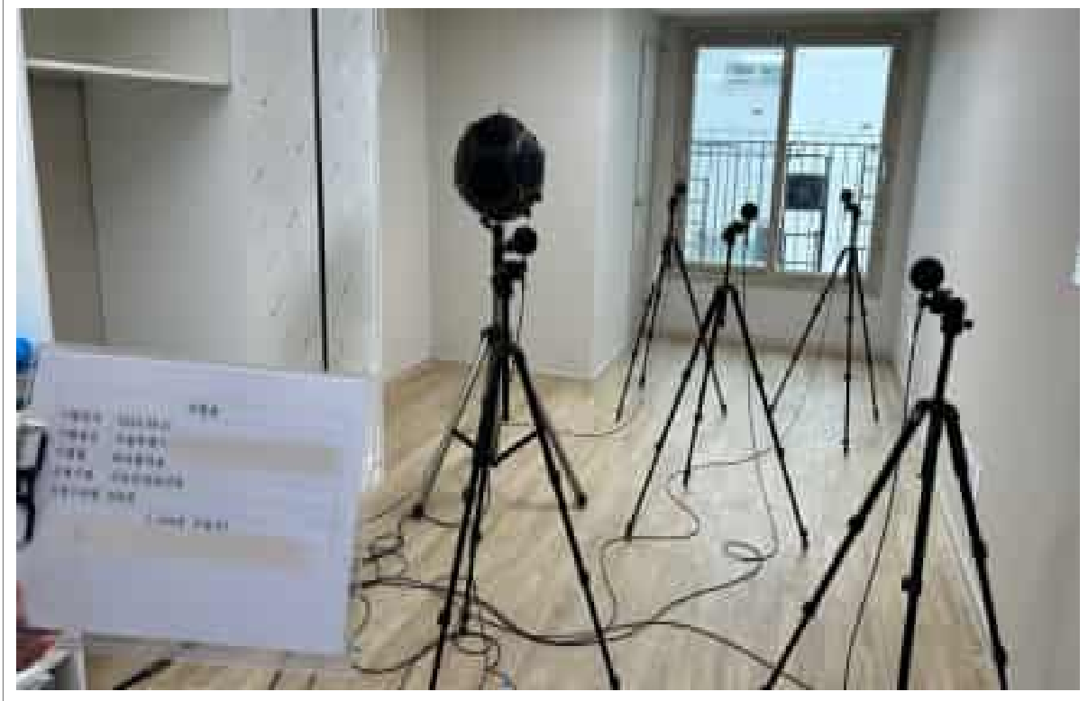
바닥충격음 성능검사 (수음실) - 음원실의 잔향시간 측정
