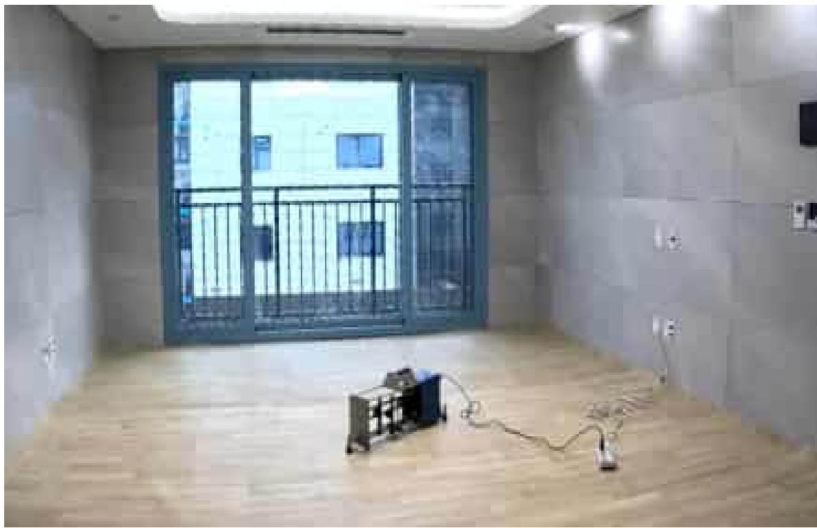
바닥충격음 성능검사 (음원실) - 경량충격음(태핑머신)
